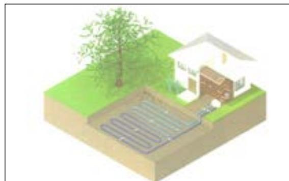
**Schéma d'un capteur horizontal.**
