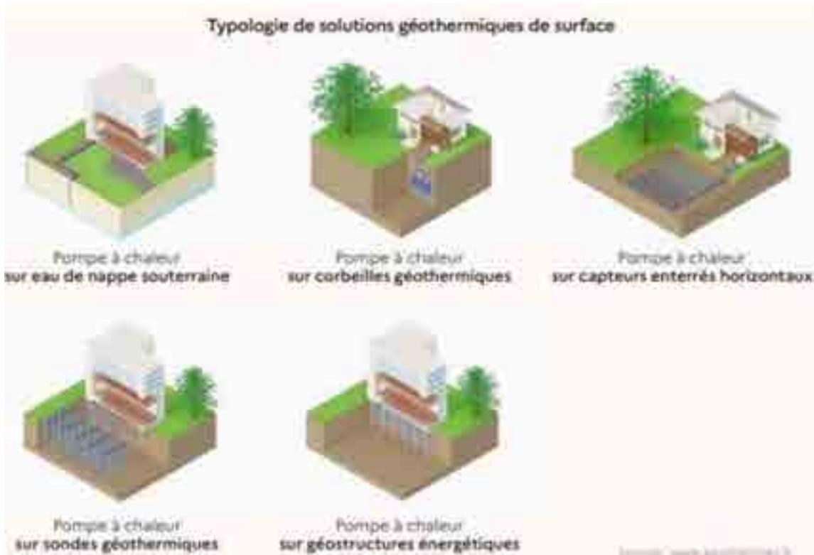
Figure 134. Types de géothermies de surface les plus courantes en France (Source : [www.geothermie.fr](http://www.geothermie.fr))
