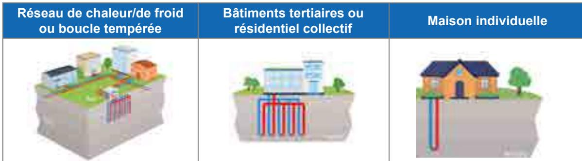
**Figure 138. Usages typiques de la géothermie sur sondes (Source : AFGP)**
