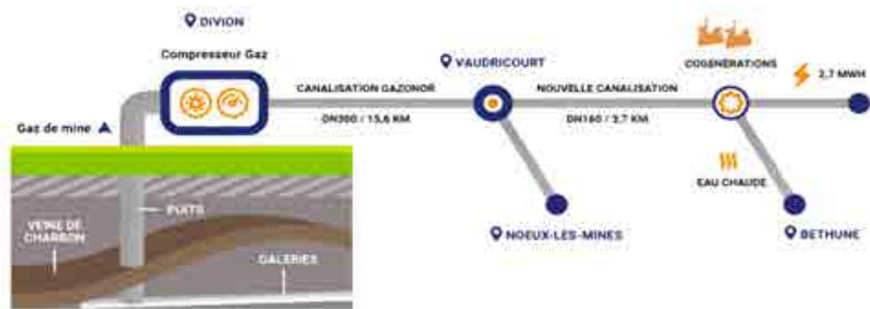
**Figure 79 : Schématisation de la valorisation de chaleur fatale à Béthune (source : Lendosphere)**
