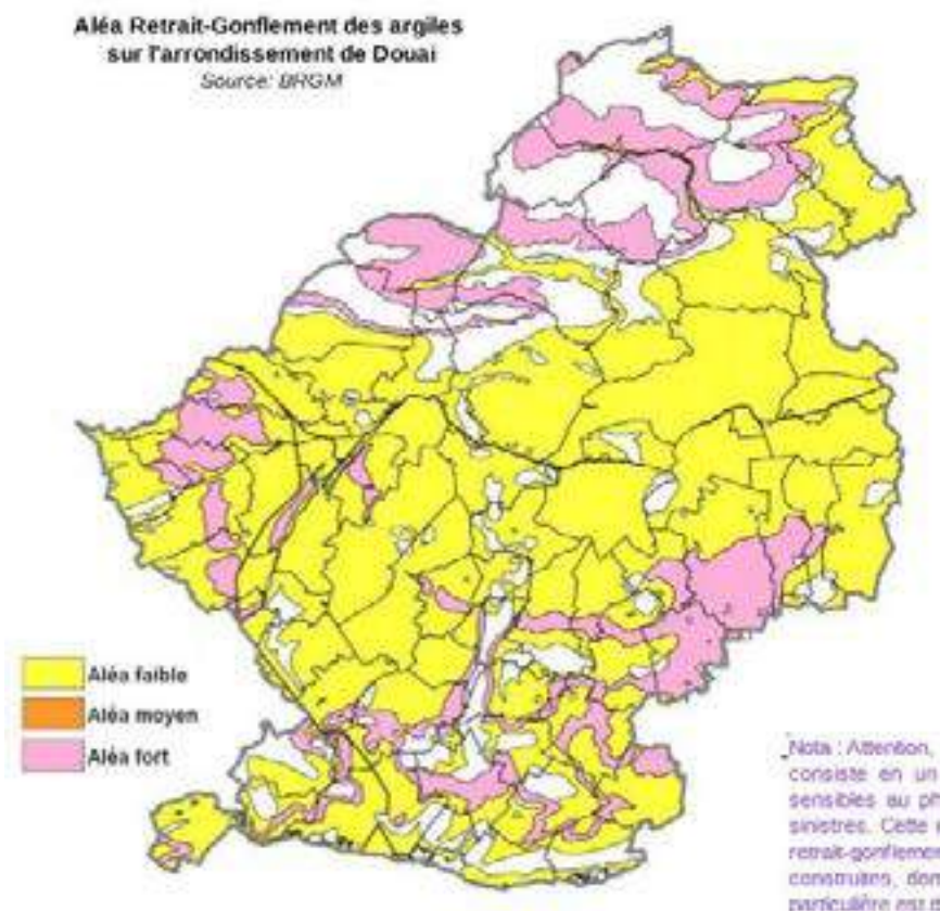
Figure 33 : Caractérisation des aléas de retrait gonflement des argiles sur l'arrondissement de Douai (Source : BRGM in DDTM du Nord – DT du Douaisis-Cambrésis, Juin 2011, Le retrait-gonflement des argiles dans l'arrondissement de Douai)
