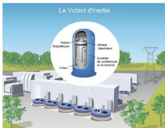
Figure 37 : Le volant d'inertie
