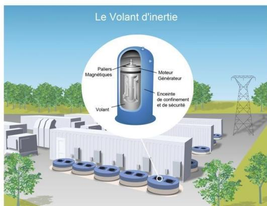
Figure 37 : Le volant d'inertie
